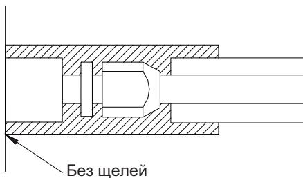
Для изоляции необходимо использовать специальный материал, который выдерживает температуру трубы линии жидкости не менее 70 °C и 120 °C линии газа.
