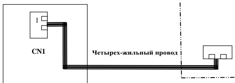
Рис. Б. Подключение провода питания и линии связи с проводным пультом управления.
