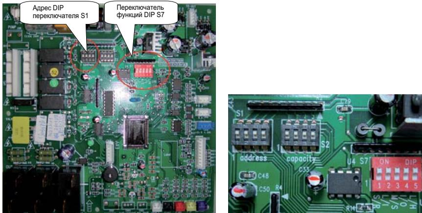
Главная плата управления, переключатель функций DIP - 5 тумблеров.
